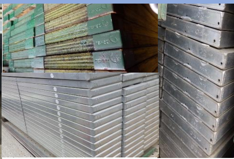
自社保有(鋼製・アルミ道板&合板足場板)2m/3m/4m
